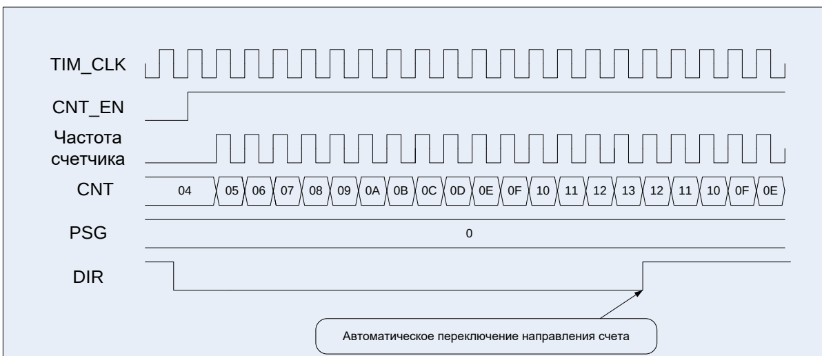
Рисунок 48 – Диаграммы работы таймера, счет двунаправленный, сначала прямой
