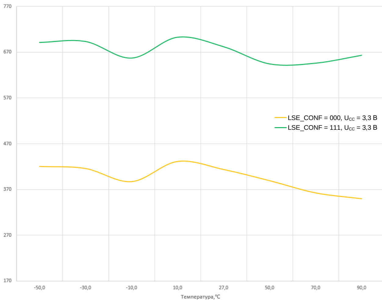
Рисунок 149 – Зависимость тока потребления генератора LSE по питанию U CCB микросхем MDR1206AFI (CHIP_ID = 215) от температуры при U CC = U CCA = U CCB = 3,3 В
